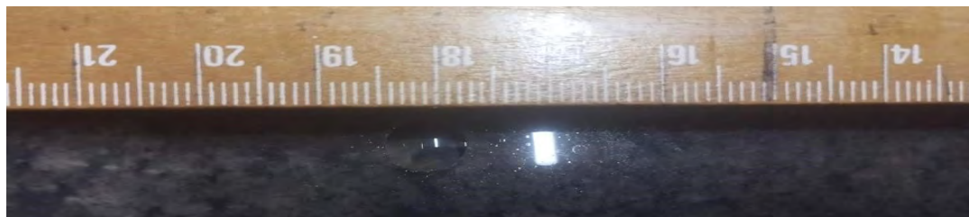
Figura 10. Medición expansión gotas de aceite mineral
