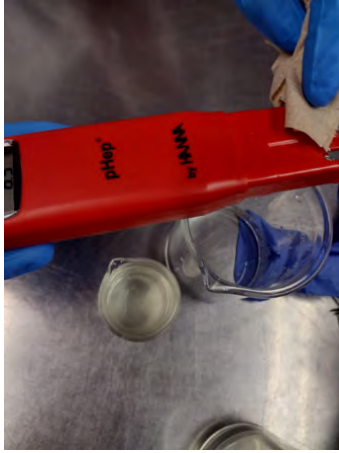
Figura 3. Determinación de pH por medio de pH-metro marca Hanna
