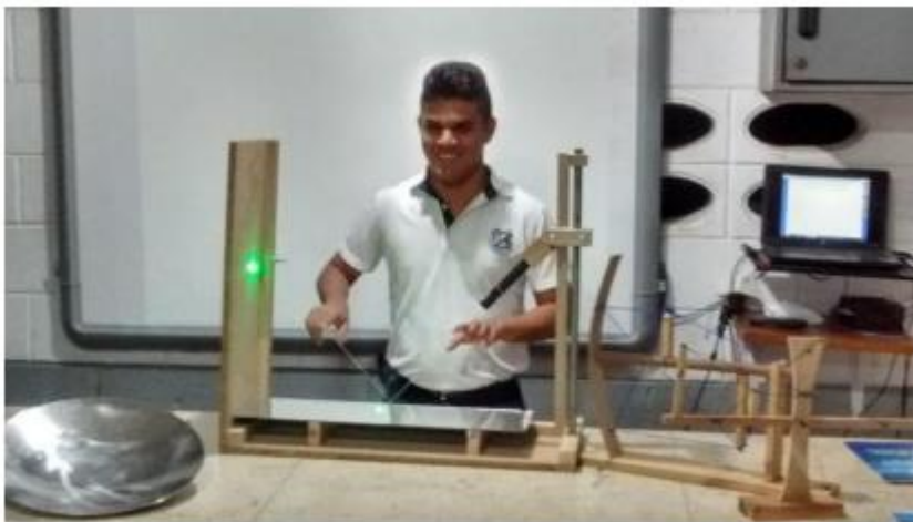
Figura 6. Prototipo para estudiar la reflexión de la luz en espejos planos.
