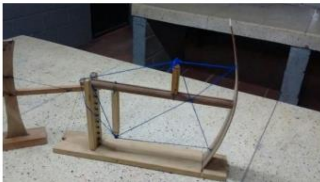
Figura 4. Prototipo para estudiar la formación de imágenes en espejos curvos
