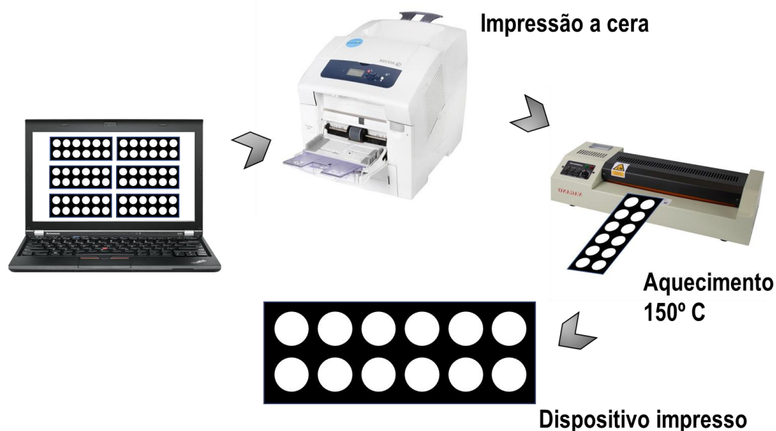
Figura 3. Representação esquemática do processo de fabricação de \mu PADs utilizando a impressão à cera.
